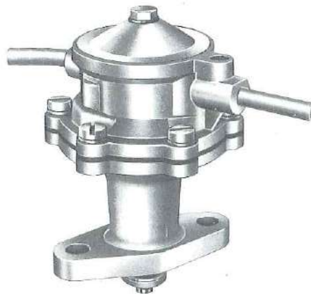
Abb. 7 Kraftstoffpumpe mit Stößelantrieb - Ansicht -
