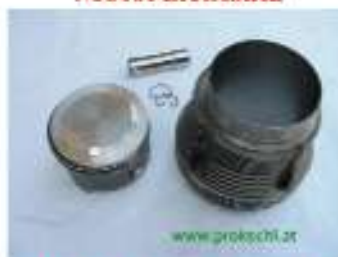
761 ccm geschmiedete Kolben + Zylinder
