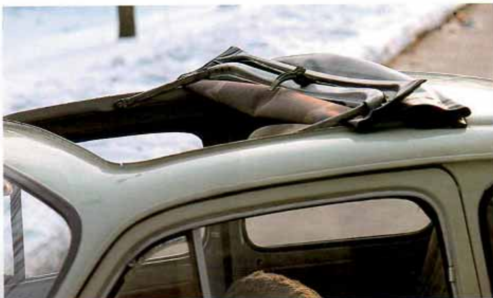
Hátra kell segíteni a vászmat kinyitáskor. Ha csak felbillentjük a keretet, a vász rövid idő alatt elvágja az anyagot, akkor pedig beázik a Puch
