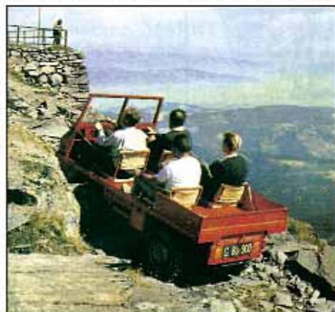
Gelegentlich spielte der Haflinger auch „Gipfel-Taxi“. Zwei Differentialsperren halfen in Extremfällen weiter.
