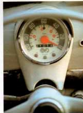
Egyedi Steyr-Puch jellemző az óramutatóval ellentétes irányban forduló sebességmérő-mutató
