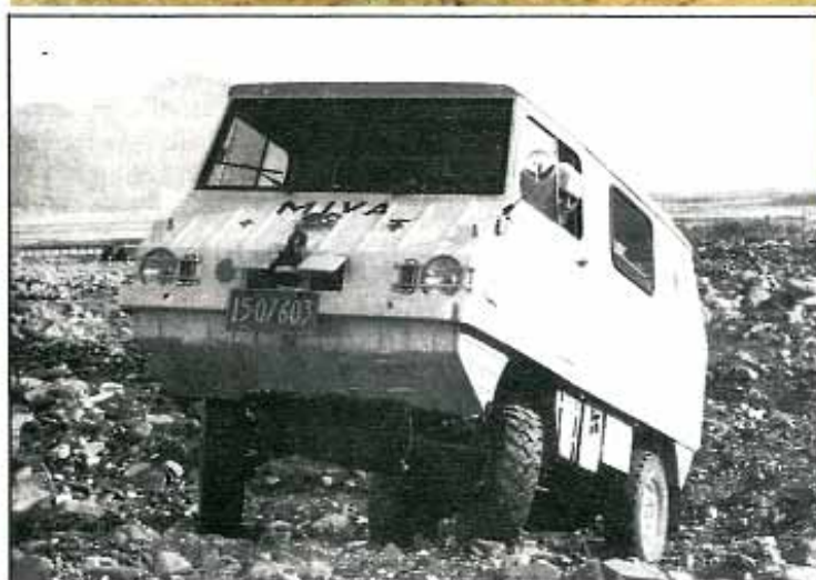
Neben der Grundversion mit offenem Führerhaus und Einfachpritsche gab's Ausführungen mit Bordwänden, Planenverdeck, festem Polyesterführerhaus und Kasten-aufbau. Links ein Ambulanzwagen auf Formosa.
