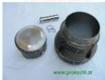
761 ccm geschmiedete Kolben + Zylinder
