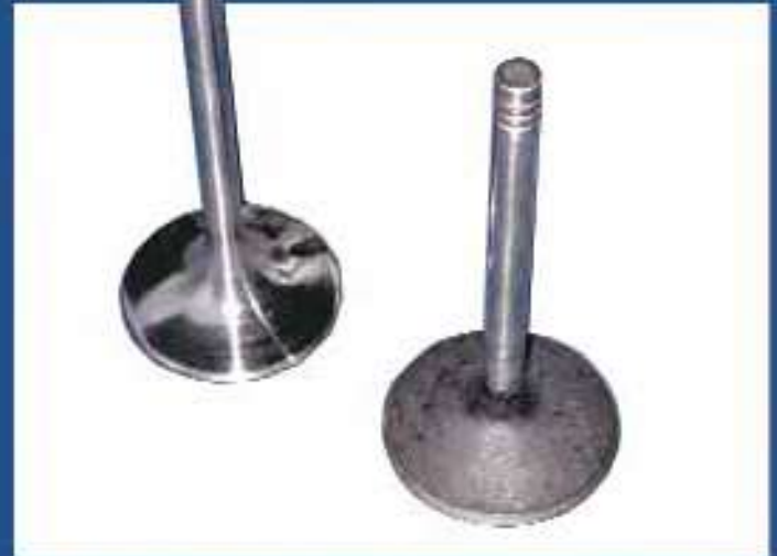
Um 20 Prozent lässt sich das Ventil durch Bearbeitung erleichtern.
