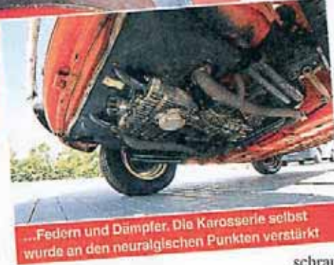
Das Fahrwerks-Layout blieb seriennah, der Stabilisator ist freilich ein Spezialteil, wie auch...
