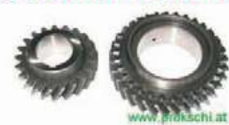
700 E Kombi Getriebeübersetzung 31:23/25:27 3./4. Gang Serie
