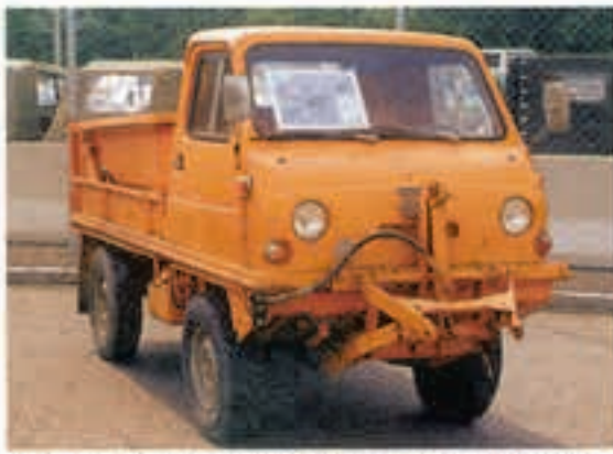
Typischer Kommunalhaflinger, so wie er Anfang der 70er gebaut wurde: Langer Radstand, Polyesterhaus, Lackierung in RAL 2000 Gelb-orange. Auf der Fahrzeugfront ist die Aufnahme für Schneeschaukel bzw. Kehrvorrichtung und andere Geräte zu sehen.
