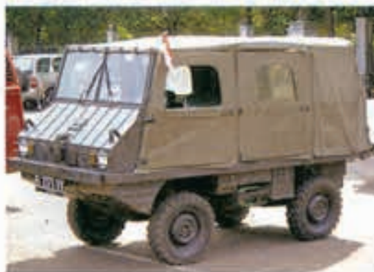
Schweizer Armeehaflinger mit Abschussvorrichtung für die Panzerabwehrwaffe „Bantam“. Das Planengestänge kann samt Windschutzscheibe nach vorne weggeklappt werden. Foto: Robert Walsh
