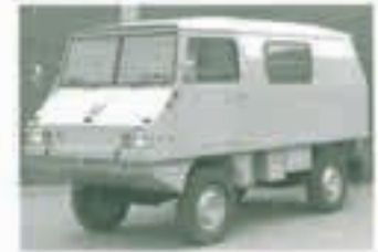
Typ 703 AP (langer Radstand) mit Aluminiumaufbau der Karosseriebaufirma Preining, der oft für Rettungsfahrzeuge herangezogen wurde.
