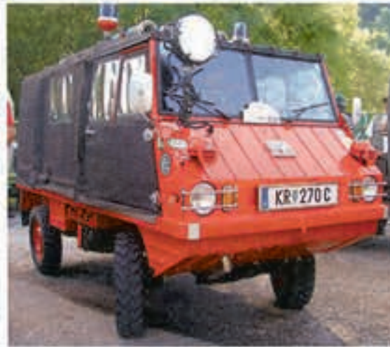
Kahlbacher Schneewiesel K2000 Bj. 1968, aufgenommen beim Grazer Hausberg, dem Schöckl, 1987. Es handelt sich um eine Version ohne Ladefläche und Planenaufbau. Die Bearbeitungsgeräte am Heck wurden mit einer Handhydraulikpumpe gehoben bzw. gesenkt. Fotos: Andreas Kiesling
