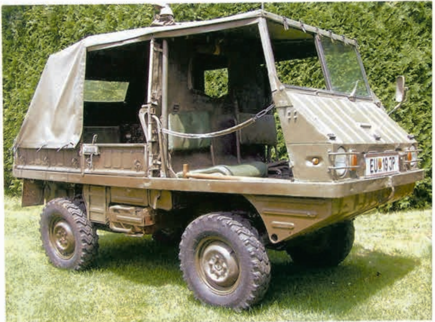
Funk-Haflinger mit Zwischenwand hinter den Vordersitzen und Antennensockeln am Dach. Der optionale Nebenantrieb kam bei diesen Fahrzeugen zum Einsatz: Die Funkbatterie wurde mit Hilfe einer zusätzlichen, am Tragrohr angebrachten Lichtmaschine aufgeladen. Rechts: Funk-Haflinger innen - rechts der Arbeitsplatz des Funkers mit Klappstisch, links die Funkeinrichtung statt des zweiten rückwärtigen Sitzes. Rechts innen: Haflinger in der Ausführung für Mannschafts- und Materialtransport beim Österreichischen Bundesheer.
