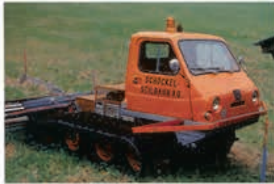
Typischer Kommunalhaflinger, so wie er Anfang der 70er gebaut wurde: Langer Radstand, Polyesterhaus, Lackierung in RAL 2000 Gelb-orange. Auf der Fahrzeugfront ist die Aufnahme für Schneeschaukel bzw. Kehrvorrichtung und andere Geräte zu sehen.
