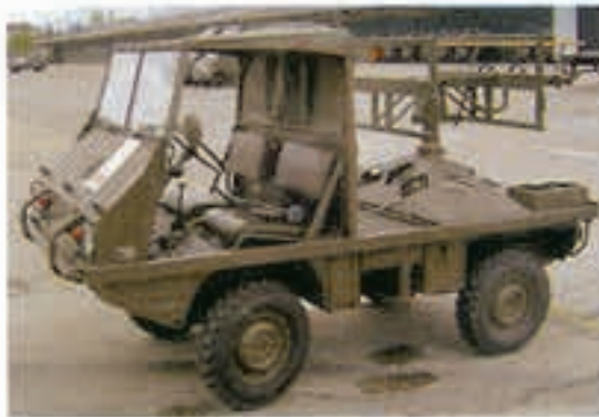
Schweizer Armeehaflinger mit Abschussvorrichtung für die Panzerabwehrwaffe „Bantam“. Das Planengestänge kann samt Windschutzscheibe nach vorne weggeklappt werden. Foto: Robert Walsh
