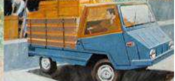
Zum Beladern von Sprengut werden ein flacher Stahlblechboden und umlaufende Holzprismen aufgesetzt.
