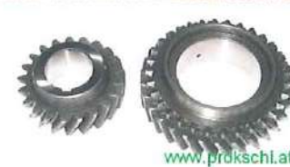
700 E Kombi Getriebeübersetzung 31:23/25:27 3/4. Gang Serie
