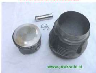
761 cm geschmiedete Kolben + Zylinder
