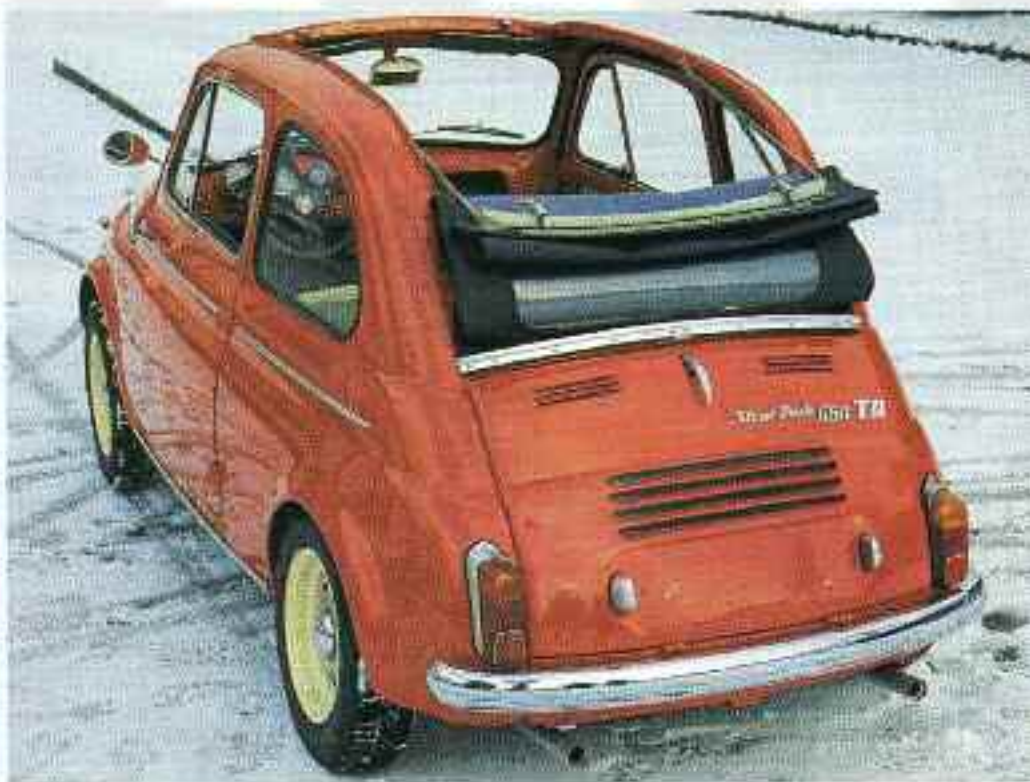
Die Urform: Bis 1967 gab es die kleinen Puch mit durchgehendem Faltdach und hinten angeschlagenen Türen. Die Nostalgieker erfreut's, seinerzeit waren Exemplare mit festem Dach treulich mehr gefragt.
