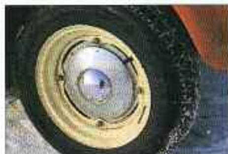
Nix Fiat: Große ATE-Alu-Trommelbremsen verzögerten die Flammhemmel aus dem Alpenland.
