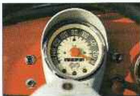
Gewöhnungsbedürftig: Der Tachometer zeigt entgegen dem Uhrzeigersinn an.
