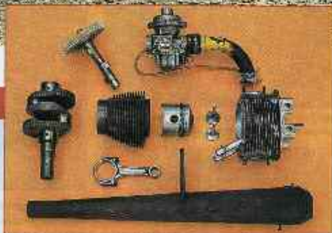
Klassisches Viertakttuning: Mit Literleistungen von fast 100 PS war man in den Sechzigern ganz vorne dabei. Verantwortlich für die...
