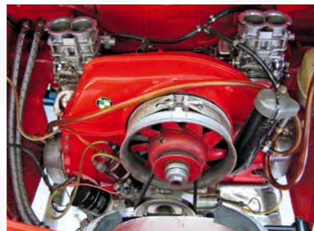
Extrem ist ohne Frage die Lösung von Walter Leuber, der auf seiner „Rennsemel“ zwei Weber Doppelvergaser DNCF 40mm fährt.
