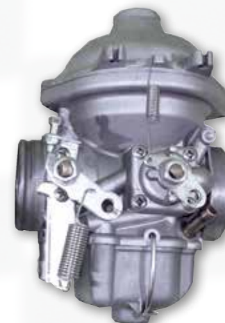
3. Gleichdruckvergaser Bing 94/Horizontal
