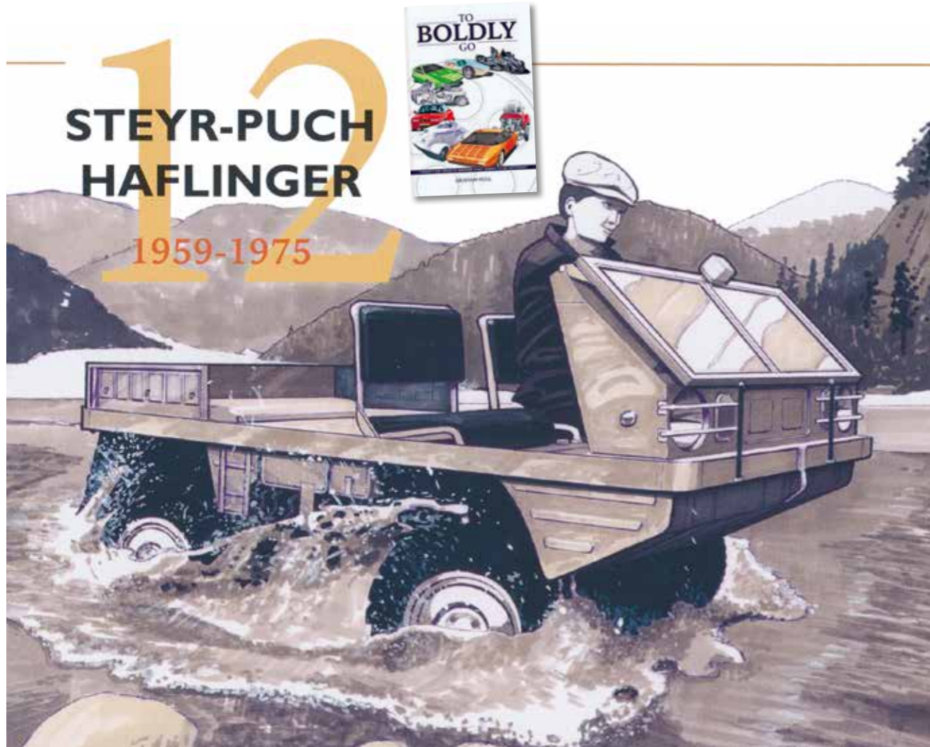
DAS STARK UNTERSETZTE GEFÄHRT MIT 643 CCM FÜHLTE SICH ABSEITS DER STRASSE AM WOHLSTEN. ES WAR MIT KURZEM UND MIT LANGEM RADSTAND ZU HABEN, MIT ZAHLREICHEN KAROSSERIEVARIANTEN, EINSCHLIEßLICH EINES GESCHLOSSENEN AUFBAUS, UND WURDE FÜR VIELE MILITÄRISCHE ZWECKE VERWENDET.
