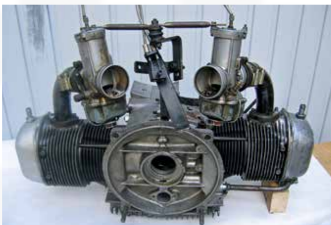
Einzelvergaser: Bing 54, Ansaugrohre-Kupfer
