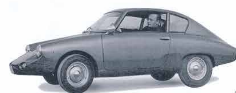
La carrozzeria Jauernig e il preparatore Moser proposero la Jamos, con carrozzeria di vetroresina. Purtroppo la presenza sul mercato di Imp e Adria fermò l'iniziativa al solo prototipo.
