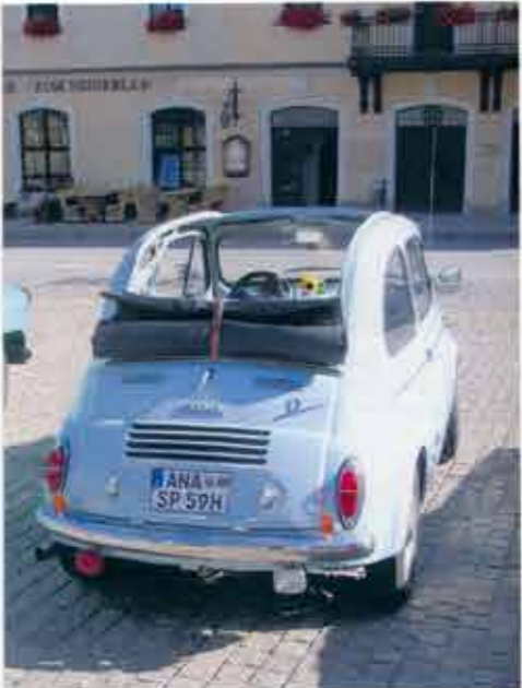
Rispetto alla 500 italiana, la Puch 500D manteneva il tettuccio apribile fino al bordo del cofano motore.
