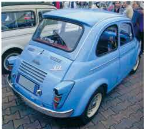
Da questa angolazione è ben visibile il tettuccio rigido con grande lunotto e le insolite luci posteriori della Steyr Puch 500 DL.
