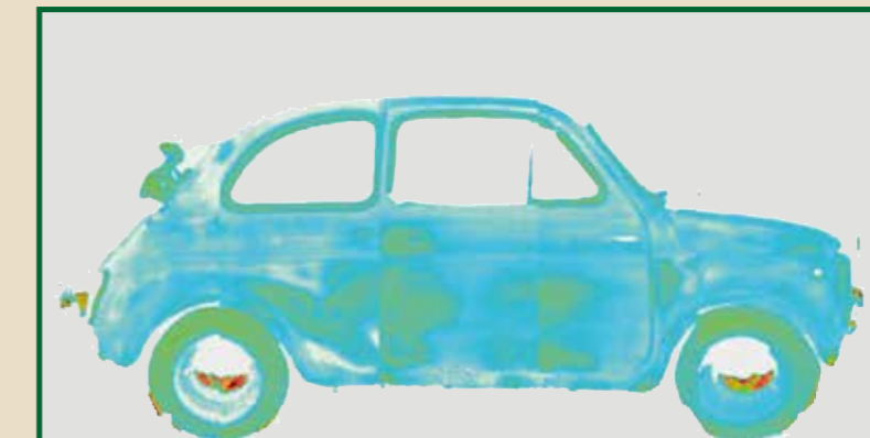
Mein Steyr Puch 650TR „Marcellos“ (Blau = Werksqualität, Rot = Schweißnähte Achsen / Stabi / Querlenker) Quelle: Carus-Finance
