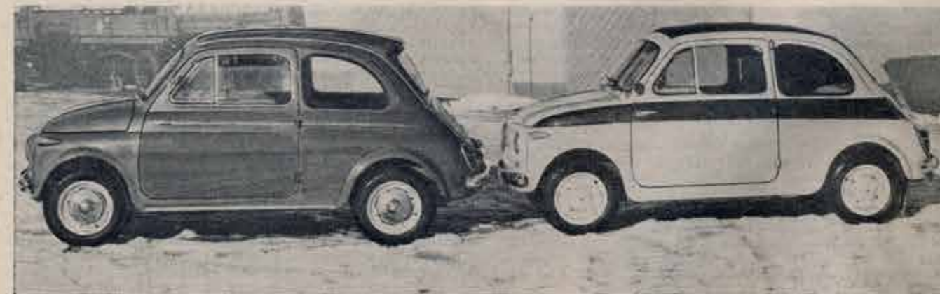
Bei der Seitenansicht des Steyr-Puch 500 fallen gegenüber dem Fiat 500 vor allem die hintere Dach-Nase und die anders geformten Feigen auf. Vergleichs-Fotos: kleinwagen (Schwab)
