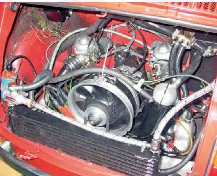
Steyr Puch Motor, 2. Ölkühler für Rücklauf (Ventilkuhlung), P.Pohl
