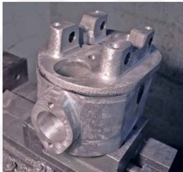
Zylinder noch ohne Kühlrippen (P. Pohl)
