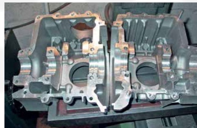
Bearbeitetes Nachguss Steyr Puch Motorgehäuse P. Pohl
