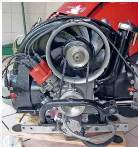
Steyr Puch Motor, Doppelzündung, Trockensumpfschmierung (P.Pohl)
