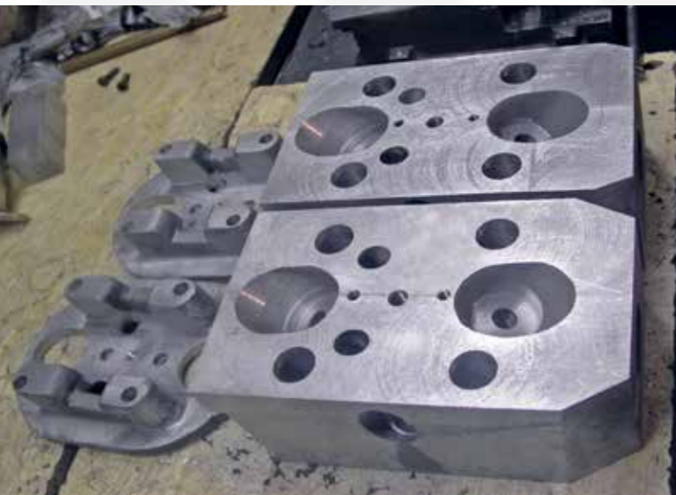
Porsche Zylinder und Kopfrohlänge (P. Pohl)
