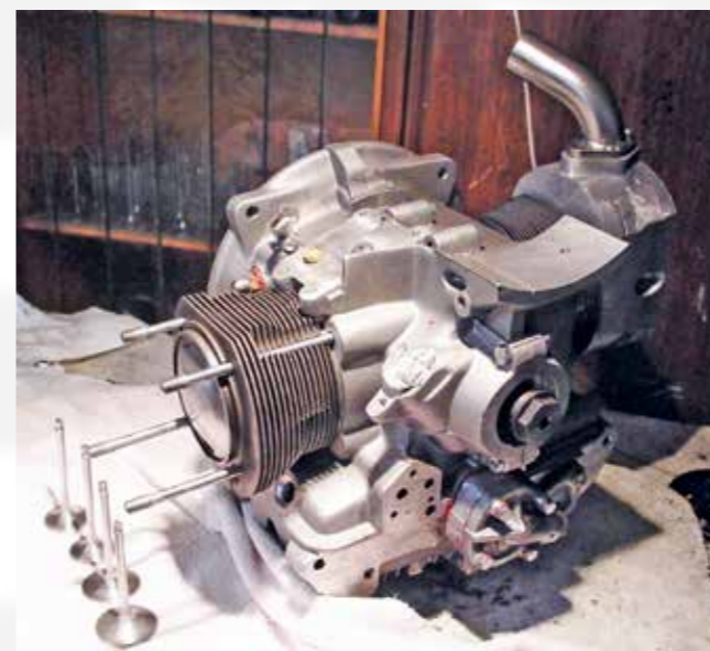
Nachgußgehäuse mit z.B. Hottinger Zylinder statt Porsche
