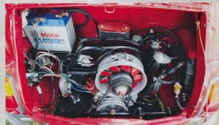
Der luftgekühlte 650 ccm Boxer ist für die raren TR 2-Rennausführungen auf 823 ccm aufgebohrt. Obwohl 9500 U/Min möglich sind, liegt der tatsächlich nutzbare Drehzahlbereich bei 7000 U/Min und ergibt damit die maximale Leistungsausbeute.
