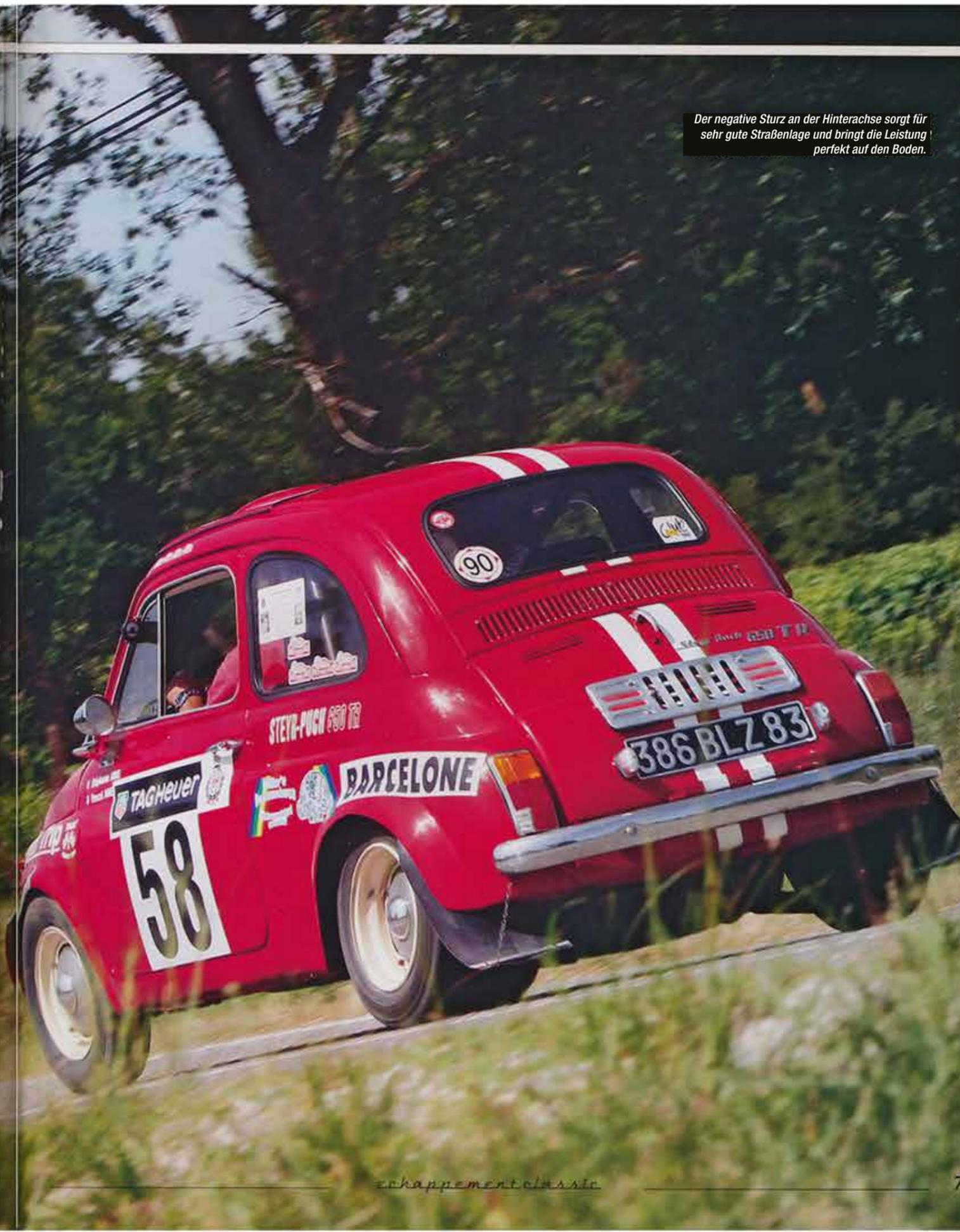
Der negative Sturz an der Hinterachse sorgt für sehr gute Straßenlage und bringt die Leistung perfekt auf den Boden.
