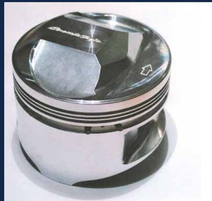
das Volumen von 3cm<sup>3</sup> erhöhen. Also schweißte ich den Dom dementsprechend auf, bearbeitete die Quetschkante, sodass ich einen konischen Spalt von 1,35mm bis 1,5mm rundum hatte. Natürlich mussten die aufgeschweißten 3cm<sup>3</sup> (umgerechnet 8,1g) an der Unterseite des Kolbenboden wieder abgefräst werden, um nicht unnötig schwer zu werden. In Wirklichkeit erleichterte ich den Kolben anstatt 8,1g um fast 12g. Leider hatte sich der Kolben durch die Schweißarbeiten dermaßen
