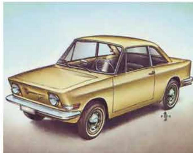
Die ersten beiden Prototypen entstanden noch auf der Bodengruppe des Puch 500. In den Fahrversuchen stellte sich jedoch heraus, dass der Radstand zu kurz war und eine längere Bodengruppe das Fahrverhalten des Fahrzeugs wesentlich verbessern würde. Die Konsequenz war daher, auf die um 7 cm längere Bodengruppe des Puch 700 C (Kombi) zu wechseln und die Holzform vor der Hinterachse zu verlängern, um die Strassenlage zu verbessern.
