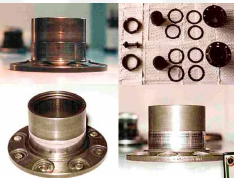
Werks-Lamellen Differential Sperre – geliehen von H. Vallant (Graz); Zusammenbau der Sperre und Einstellung: Ecki Spelsberg (BMW), 9er-Tellerrad abgeschliffen H. Hearing; Getriebe distanziert H. Liedl.
