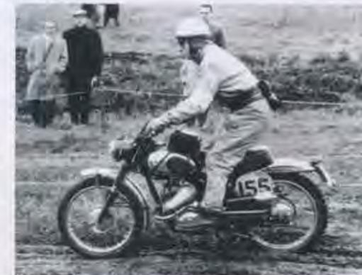
Knapp 11,5 PS leistete der Doppelkolbenzweitakter, der durch zwei Vergaser – an jeder Seite einer – gespeist wurde, saugte seine Luft über jeweils hochgelegte Filter an, hier sehr gut erkennbar. Insgesamt wirkte die Puch sehr kompakt und filigran.
