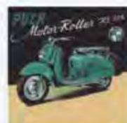
1957 brachte Puch zwei neue Modelle heraus. Den 125SR und den 150SR. Die Version 150SR hatte mit 150ccm, 6PS. Beide Varianten gab es auch alternativ mit elektrischen Anlasser. Diese wurden unter dem Namen 125SRA und 150SRA verkauft. Außerdem hatten sie schon eine Langschwinge und eine Zweifarben Lackierung. Zur Auswahl standen die Farben hellblau / dunkelblau, rot / beige und anthrazit / beige.
