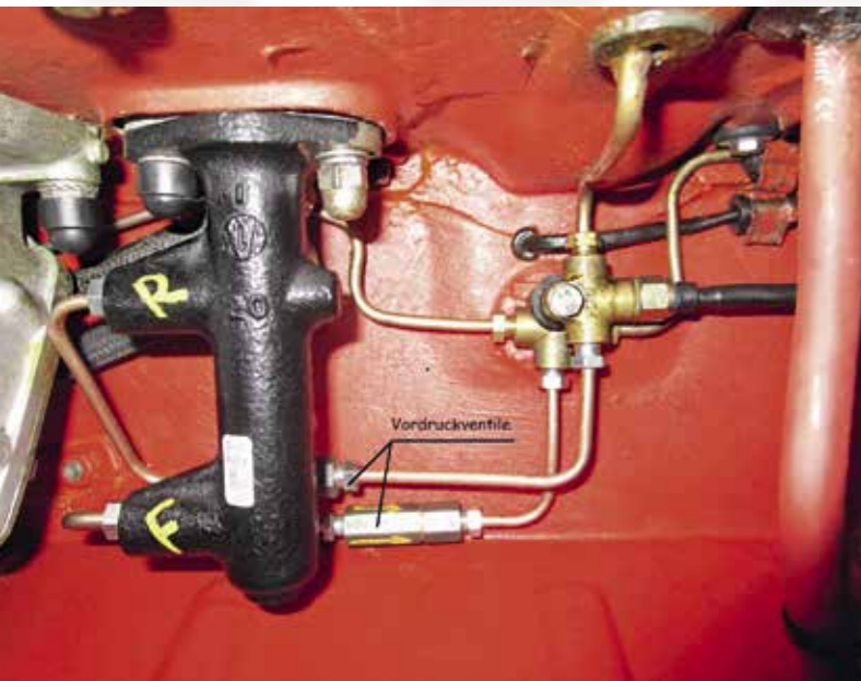
Einbau ATE Tandem-Hauptbremszylinder/Vordruckventile/Bremsdruckschalter
